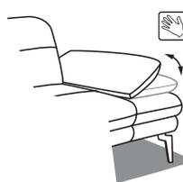
Mittels eines Rasterbeschlags lassen sich die Armlehnen in ihrer Neigung verstellen. Durch Ziehen über die letzte Einrastposition hinaus lässt sich die Armlehne wieder in ihre flache Ausgangsposition zurücksetzen. Die Armlehnenverstellung ist gegen Aufpreis erhältlich.
