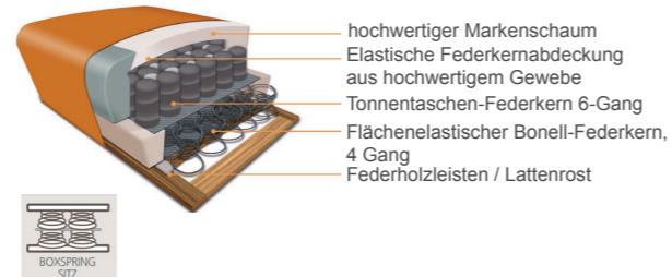
Boxspringsitz mit Bonell-Federkern und Tonnentaschenfederkern. Achtung! Bei dieser Ausführung erhöht sich die Sitzhöhe auf 48 cm!
